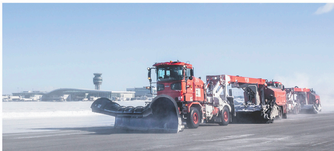
Les trois véhicules équipés de chasse-neige, de balais et des produits déglacants forment un mur d'une largeur de 18,2 mètres (60 pieds).
