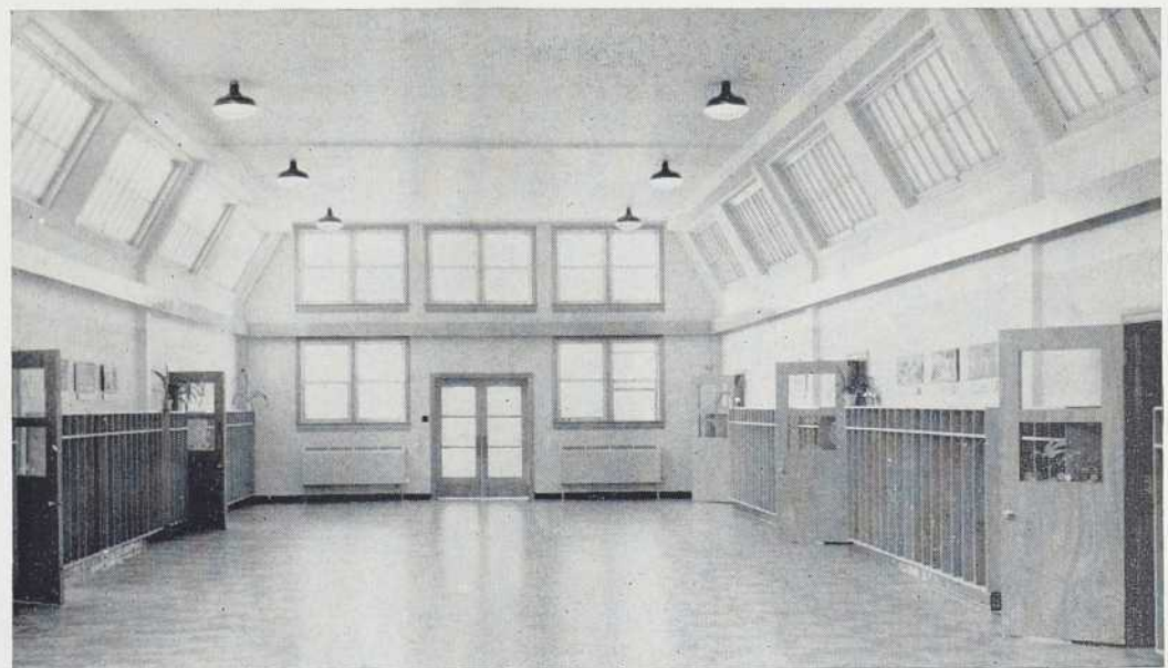
La grande salle de jeux. Les classes sont disposées sur les deux longs côtés de celle-ci. Maximum d'accessibilité et élimination des couloirs.
