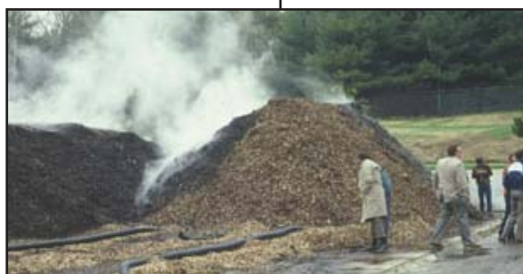
Piles statiques sous aération forcée Photo : SOLINOV
