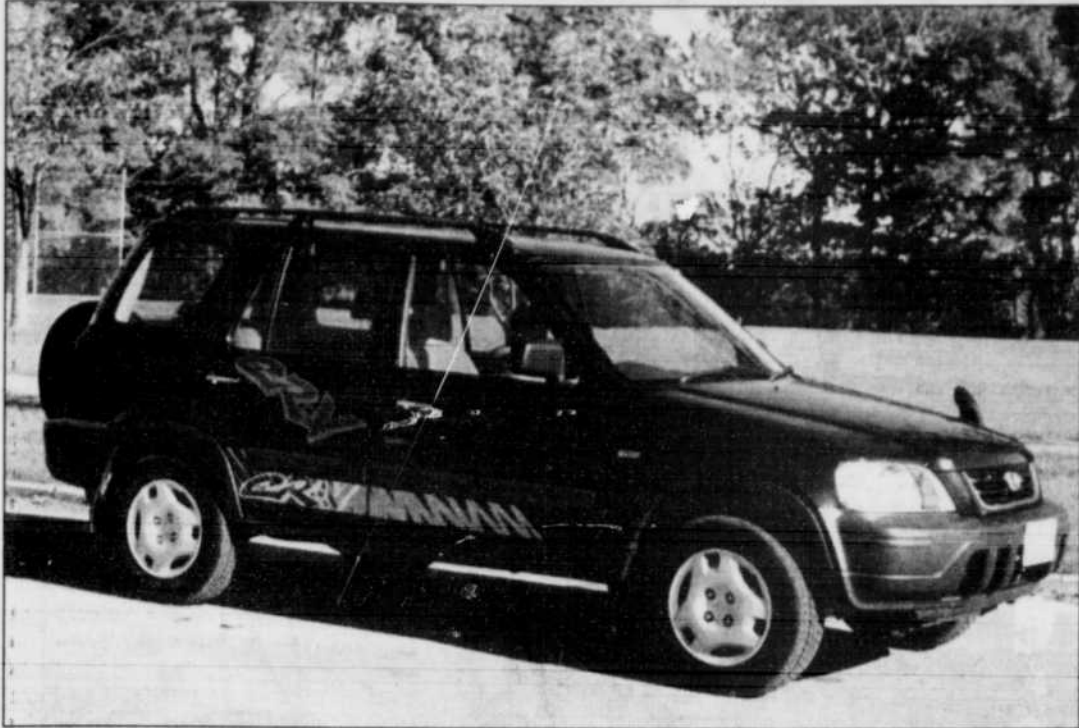
COLLABORATION SPÉCIALE MARCEL COLLARD Le véhicule à traction intégrale est mû par un moteur 4 cylindres, 2 litres, 131 CV.
