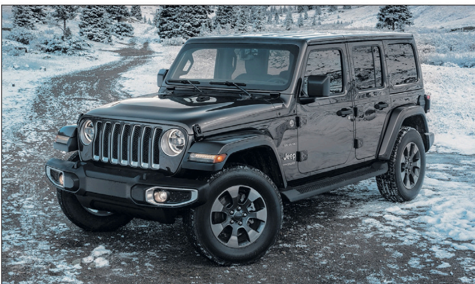
Jeep a redessiné et solidifié le Wrangler JL 2018. Désormais, trois moteurs sont offerts: V6 de 3,6 l (285 ch), L4 turbo de 2,0 l (270 ch) et V6 turbodiesel de 3,0 l (260 ch).
