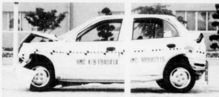
Zones déformantes avant et arrière conçues pour absorber le choc lors de collisions.
