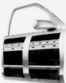
Deux poutrelles latérales de renfort pour une meilleure protection en cas d'impact latéral.
