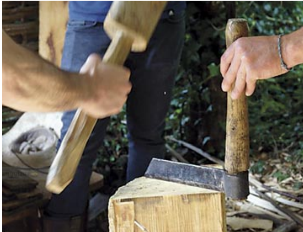
Départoir (hache) et maillet de bois artisanal pour fabriquer des tavaillons ou bardeaux de bois.
