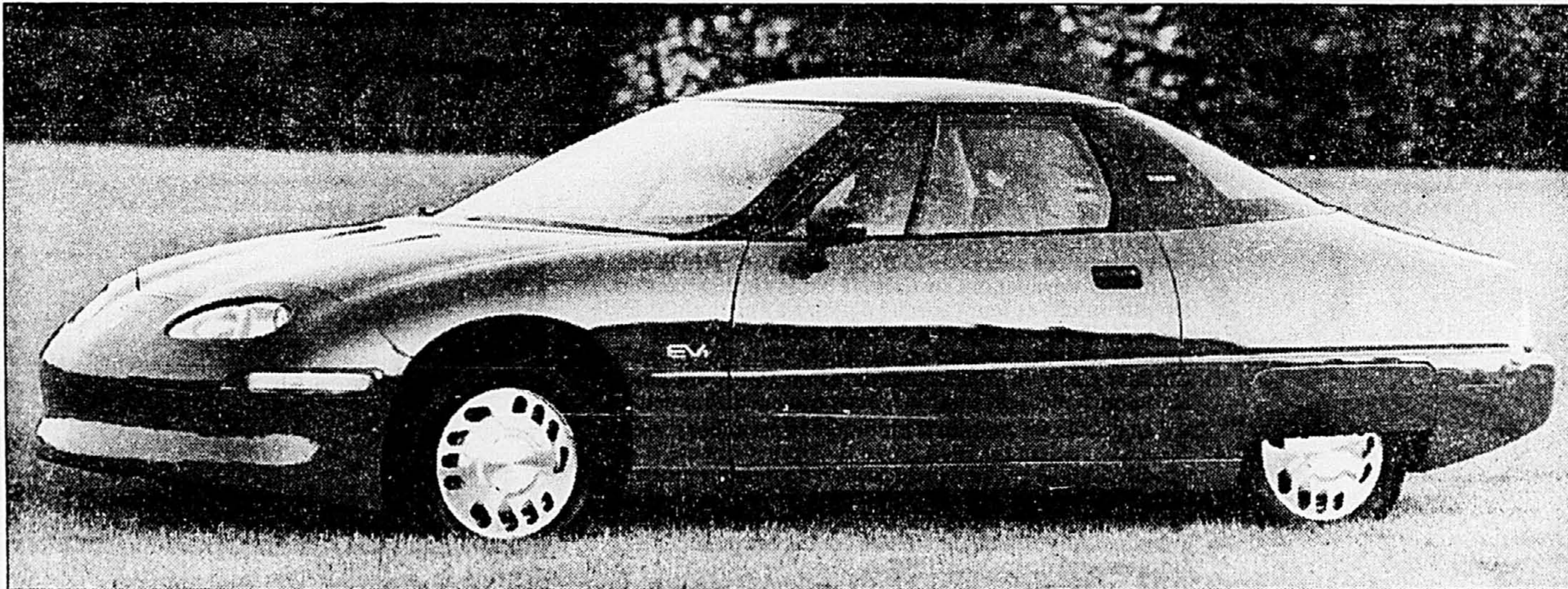
La voiture électrique EV1 de General Motors utilise des freins entièrement électriques aux roues arrière.
