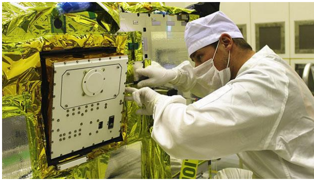
Avant le lancement de la sonde Hayabusa 2, un technicien installe sur elle la sonde MASCOT, un cube d'une trentaine de centimètres... qui s'est finalement posé sur Ryugu le 3 octobre.
