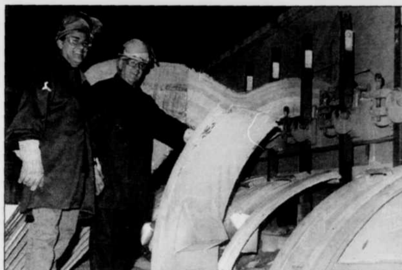
De leur côté, René Bertrand et Louis-Joseph Gagnon posent devant un capot amélioré qui s'ouvre beaucoup plus facilement qu'avant et sans risque d'accrocher les anodes.
