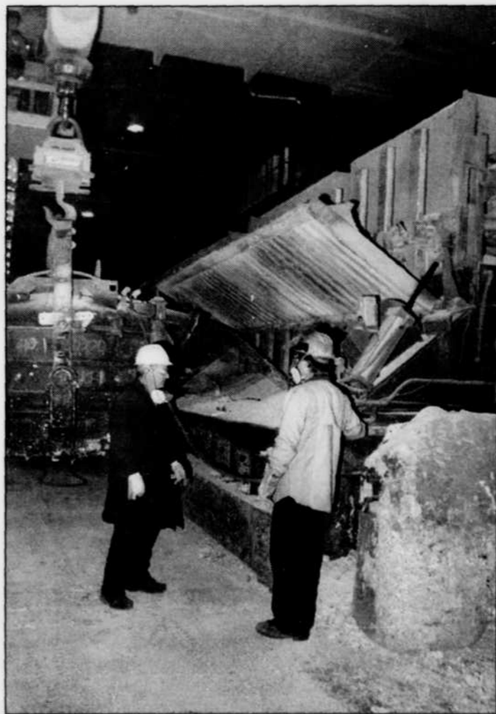
Bernard Bouchard et Luc Salesse, pontier/siphonneur, observent une scène de siphonnage à la salle de cuves 40.
