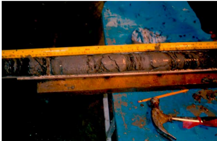
FIGURE 5.15 : LENTILLES DE GLACE ÉPAISSES FORMÉES AUX CONTACTS STRATIGRAPHIQUES ENTRE DES COUCHES DE SABLE ET DES COUCHES D'ARGILE À UMIUJAQ.
