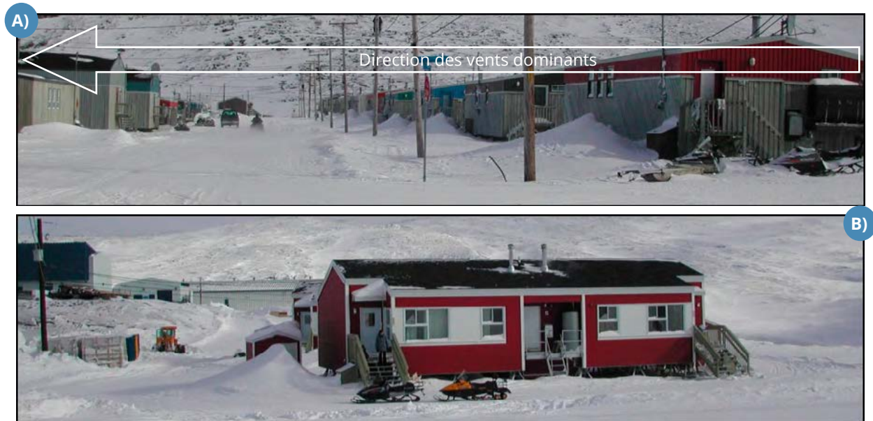
FIGURE 5.88 : A) MAISONS DONT L'AXE DE LONGUEUR EST PERPENDICULAIRE AUX VENTS DOMINANTS. B) MAISON DONT L'AXE DE LONGUEUR EST PARALLÈLE AUX VENTS DOMINANTS (TIRÉ DE ALLARD ET AUTRES, 2010).
