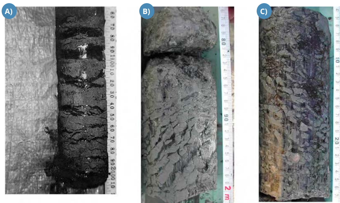
FIGURE 5.10 : DIFFÉRENTS TYPES DE GLACE DE SÉGRÉGATION : A) LENTILLES, B) GLACE RÉTICULÉE, C) GLACE D'AGGRADATION.
