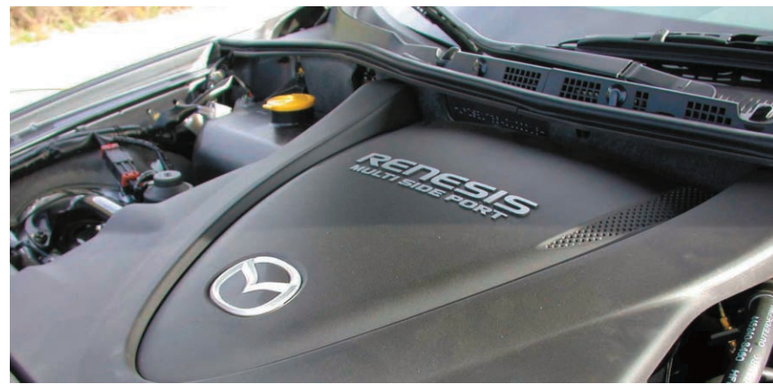
Le moteur Renesis ne pèse que 125 kg. Il est composé de quatre pièces au lieu, à titre d'exemple, de 40 pour un 4 cylindres 2 litres.
