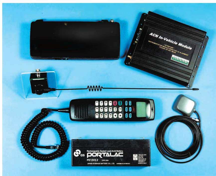
Le système d'alerte automatique en cas de collision (Automatic Crash Notification System) mis au point par la compagnie américaine Veridian, peut envoyer un message de détresse instantanément au centre d'appel 911 le plus près.
