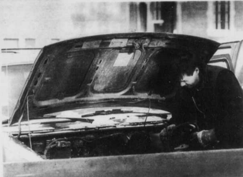
HUILE - Votre inspection sous le capot devrait comprendre la vérification du liquide de transmission, de freins, de servo-direction, d'antigel et de lave-glaces de même que le niveau d'huile du moteur.
