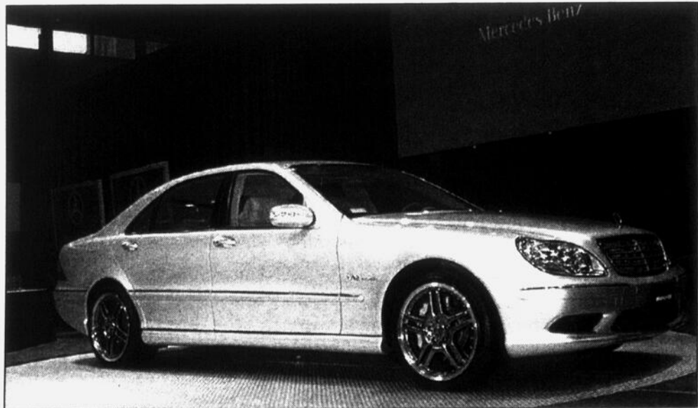
La Mercedes-Benz S65 AMG sera l'une des plus rapides berlines au monde avec son moteur V12 de 6,0 litres à double-turbo développant une puissance de 604 chevaux et un couple de 738 lb-pi.
