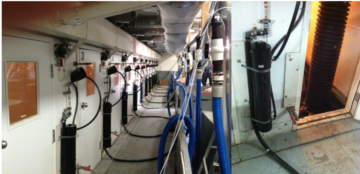
Figure 9 : Douze mini-biofiltres installés au laboratoire BABE de l'IRDA (Source : Girard, M. et Belzile, M., 2013)
