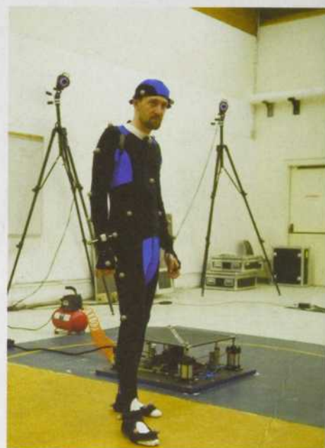
La technique MOCAP permet d'étudier les mouvements du corps en temps réel à l'aide de capteurs. Elle était initialement utilisée dans le milieu médical en orthopédie, en traumatologie et en rééducation. Aujourd'hui, on y a recours couramment dans l'animation virtuelle pour concevoir des films en 3D ou des jeux vidéo.
