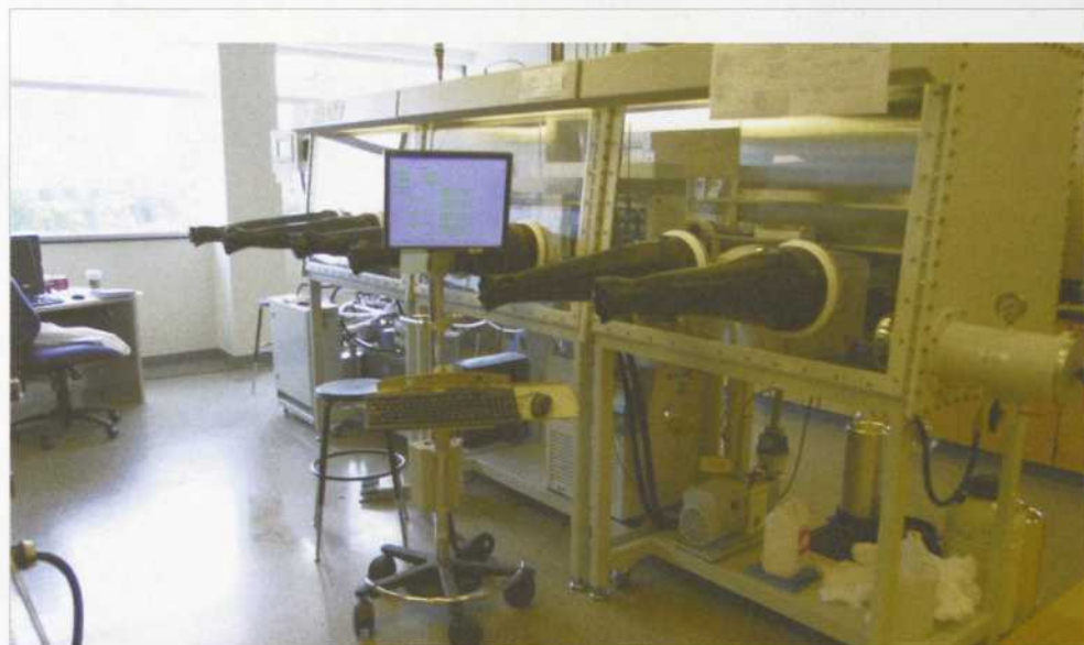
Le Centre de recherche et d'innovation en catalyse possède un robot permettant de produire 96 réactions chimiques en parallèle. Plusieurs de ces réactions étant sensibles en présence d'oxygène ou d'eau, l'appareil est installé de façon permanente sous une atmosphère d'azote. On aperçoit ici un élément de ce robot, la triple boîte sèche.
