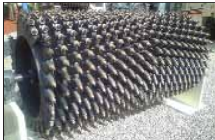
Figure 2 : Tambour pour du micro-planage
