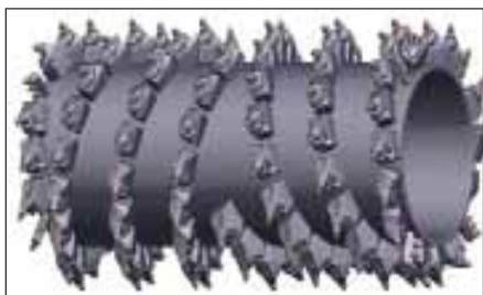
Figure 1 : Tambour pour du planage conventionnel
