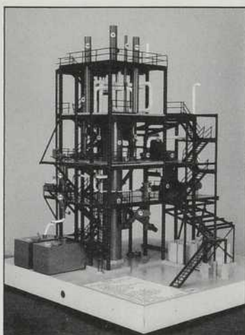
L'unité de gazéification Biosyn transforme la matière organique en un gaz de haute valeur.
