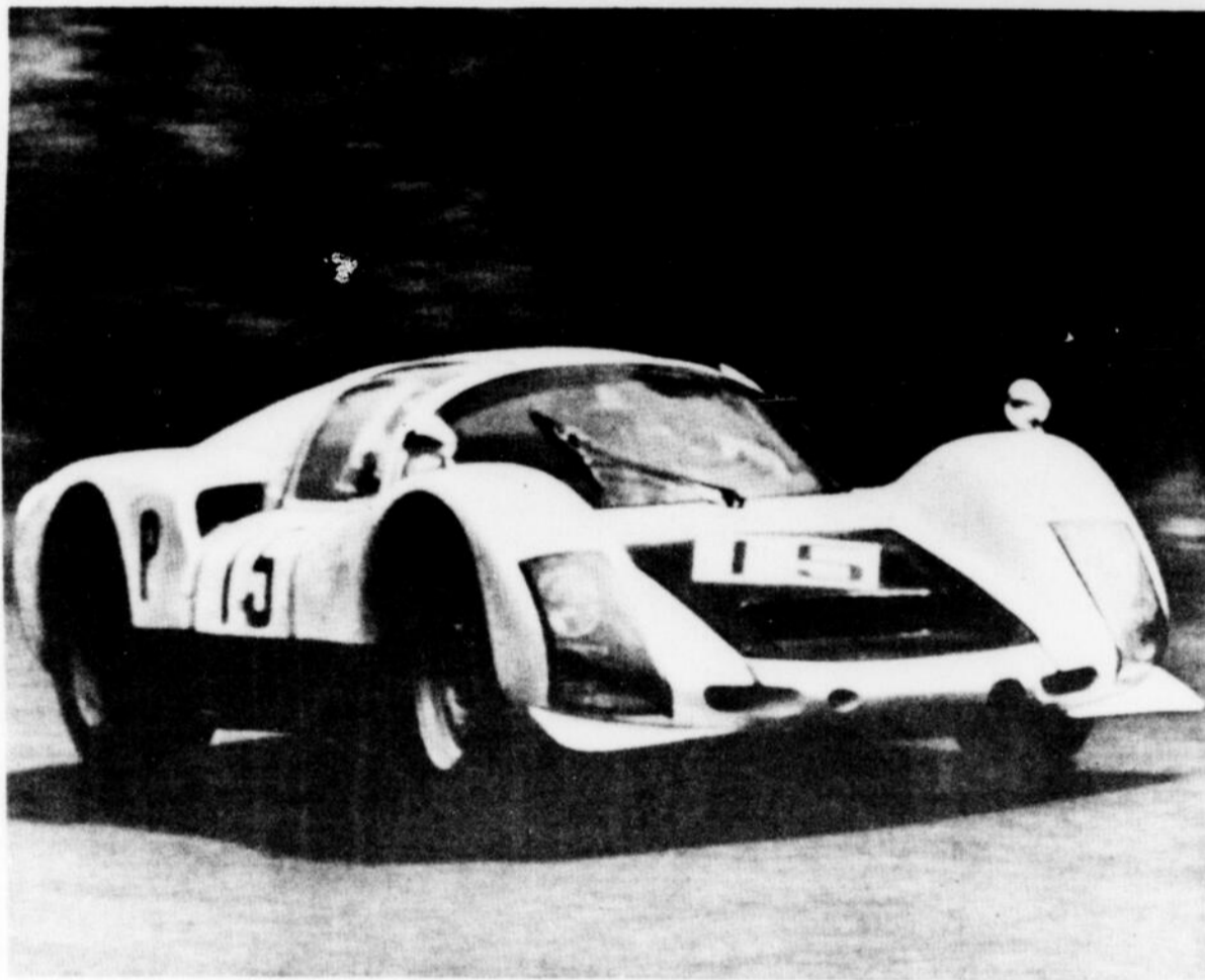
JACQUES DUVAL n'est pas le moins bien organisé des conducteurs de voitures de courses. Il est le propriétaire de cette magnifique Porsche Carrera 6, d'une valeur de $14,000. Cette voiture qui ne pèse que 1,250 livres est capable d'une vitesse de 180 mph.
