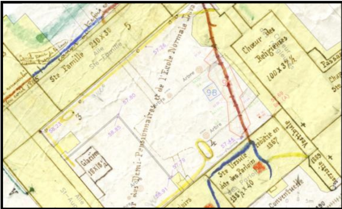
Figure 40. Superposition du plan des réseaux souterrains pour l'évacuation des eaux dans la cour intérieure, avec le plan d'intervention archéologique de 2015. Le trait jaune indique une canalisation en bois, tandis que le rouge représente des tuyaux de grès. Plan original daté de 1878, mais annotations manuscrites en 1895. Archives du Monastère des Ursulines de Québec, 1/N. 8.2.1.30.
