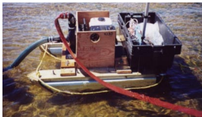
Photo 3. Système d'échantillonnage Venturi utilisé pour l'échantillonnage des parcelles expérimentales.
