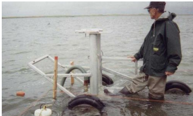
Figure 2. Râteau hydraulique utilisé pour la récolte de myes dans les lagunes aux Îles-de-la-Madeleine.
