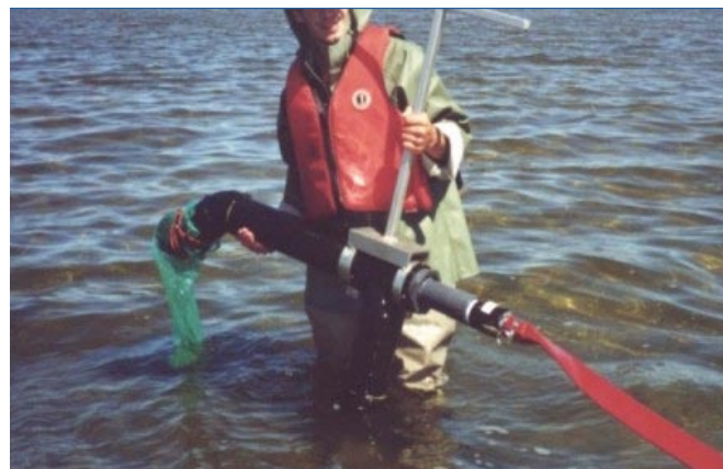
Photo 3. Système d'échantillonnage Venturi utilisé pour l'échantillonnage des parcelles expérimentales.
