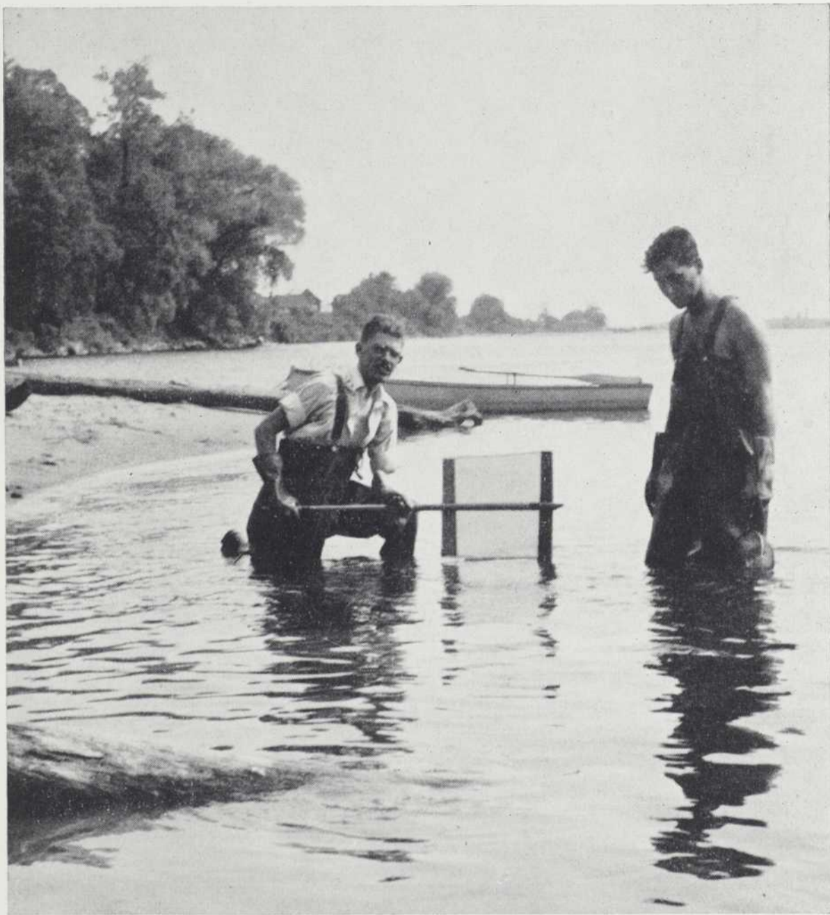
FIGURE 10.— Collection des Ammocètes à l'aide du courant électrique, sur la rivière Ste-Anne, près de Ste-Anne-de-la-Pérade. A gauche, un assistant tient l'électrode en treillis de fer galvanisé et, à droite, un autre muni d'un tamis est prêt à prendre les Ammocètes. (Photo par l'auteur).
