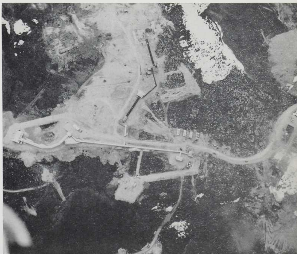
Une vue aérienne de la rampe de lancement située à Fort Churchill, au Manitoba. Des fusées Black Brant partent du bâtiment que l'on aperçoit à l'extrême gauche. C'est la seule rampe de lancement enfermée en Amérique du Nord. Les dures conditions climatiques de cette région ont obligé les constructeurs à relier les bâtiments par des tunnels.
