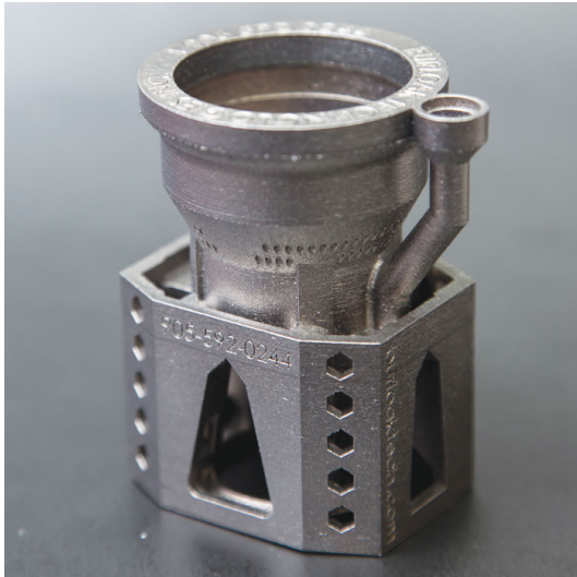
Figure 16 : Composant aérospatial complexe imprimé sur sa face interne et externe grâce à la fabrication additive (©Burloak Technologies and FMA Communications Canada, 2015)
