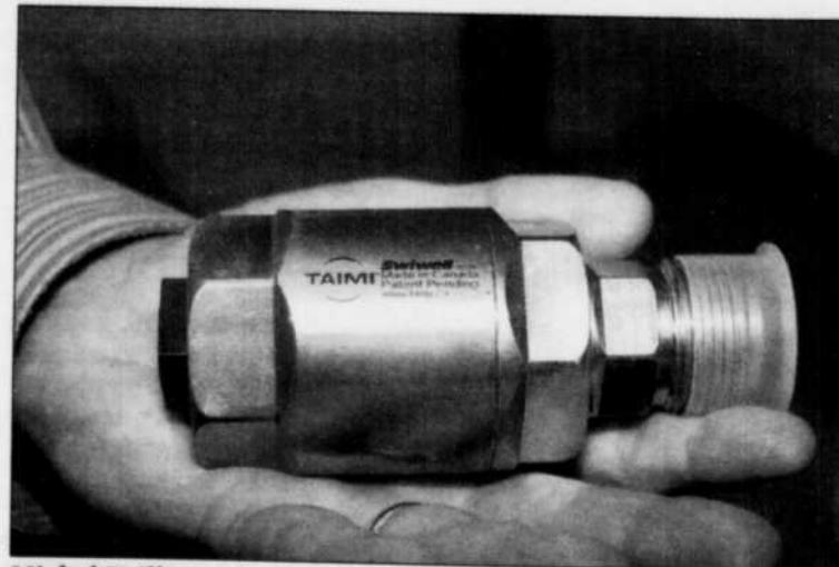
Michel Taillon a développé un raccord tournant qui empêche la torsion des boyaux utilisés en hydraulique.
