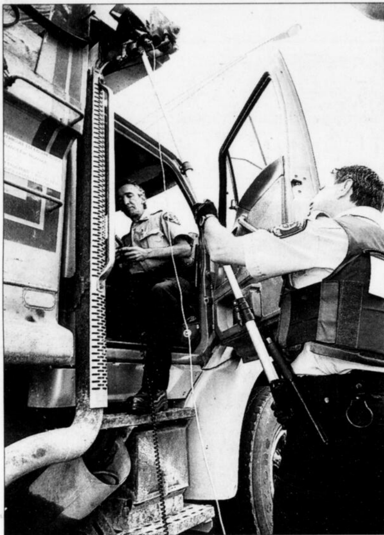
L'opacimètre permet de vérifier le taux d'opacité de la fumée d'échappement des véhicules lourds.
