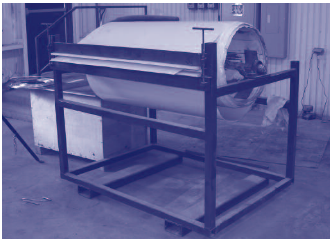
Support pour rouleau de feuilles d'aluminium
