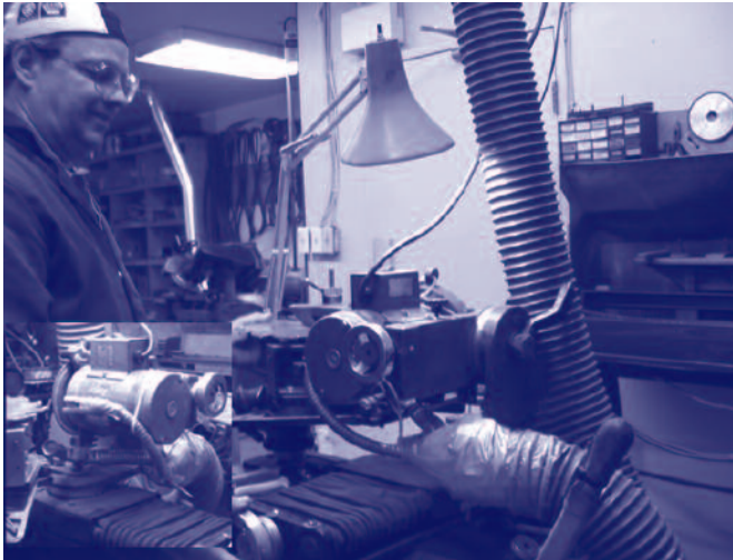
Système d'aspiration avec bras de captation
