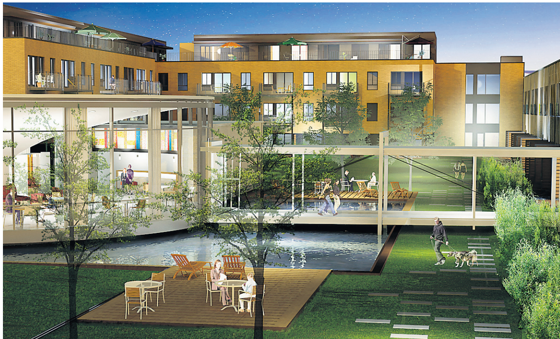
ILLUSTRATION FOURNIE PAR LE GROUPE CARDINAL HARDY L'ancien siège social de Novartis (à droite) est relié à l'arrière à un pavillon circulaire, suspendu au-dessus d'un plan d'eau, qui deviendra l'Espace Club. On voit une des ailes en forme de L qui sera ajoutée autour de la rotonde pour servir d'écran contre le bruit de l'autoroute 20. L'espace sera ainsi fermé pour créer des jardins intérieurs.
