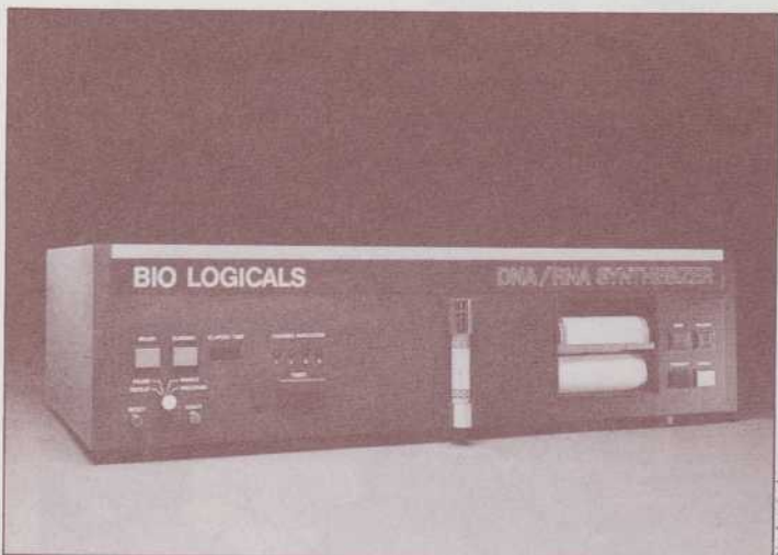
Le synthétiseur d'ADN-ARN mis au point par Bio Logicals représente, malgré son aspect plutôt banal, une petite révolution dans le monde de la biotechnologie.
