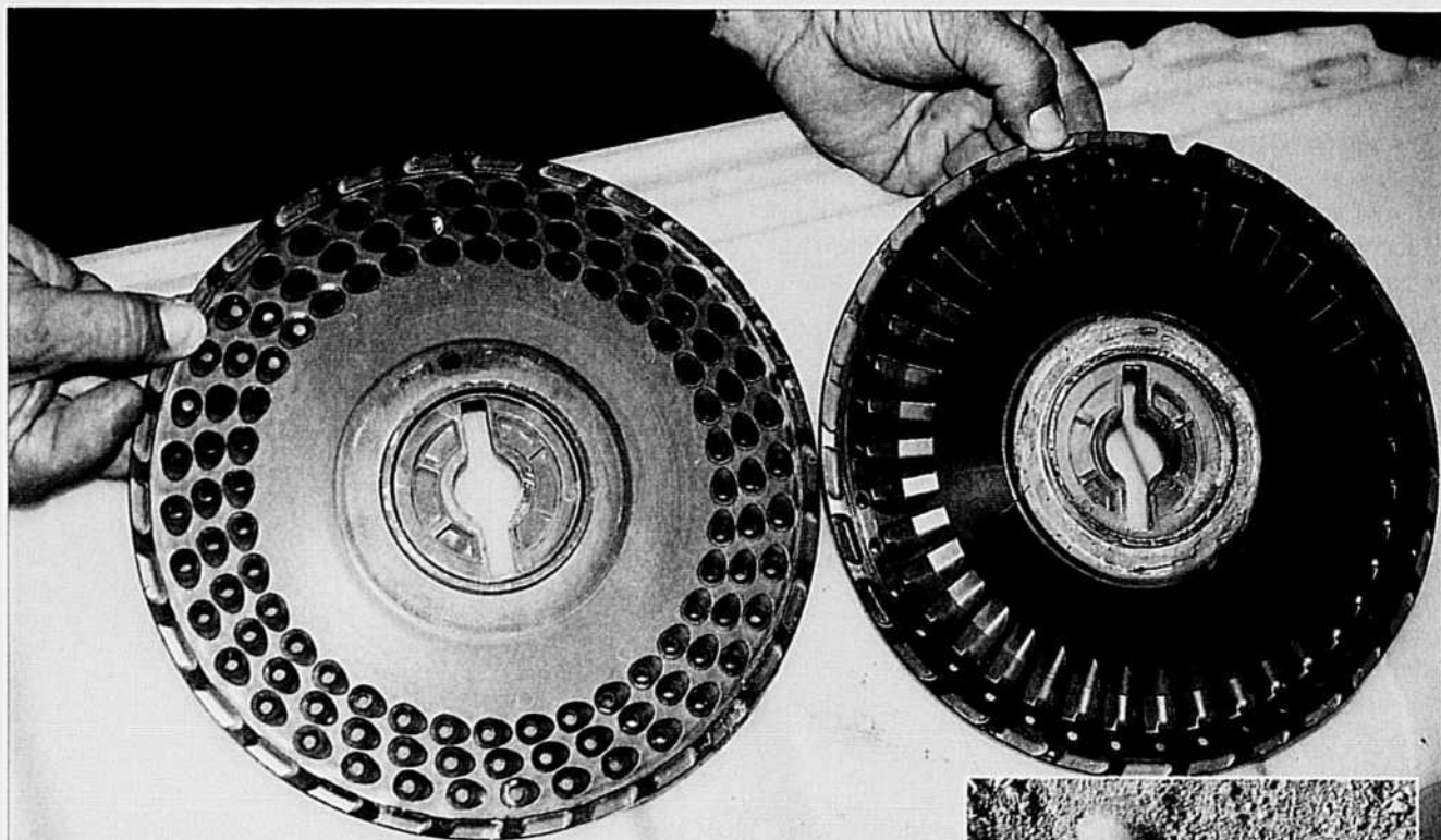
Chez les planteurs, les disques à soya (à gauche) comportent plus de rangées de trous, contrairement à ceux destinés au semis du maïs (à droite).
