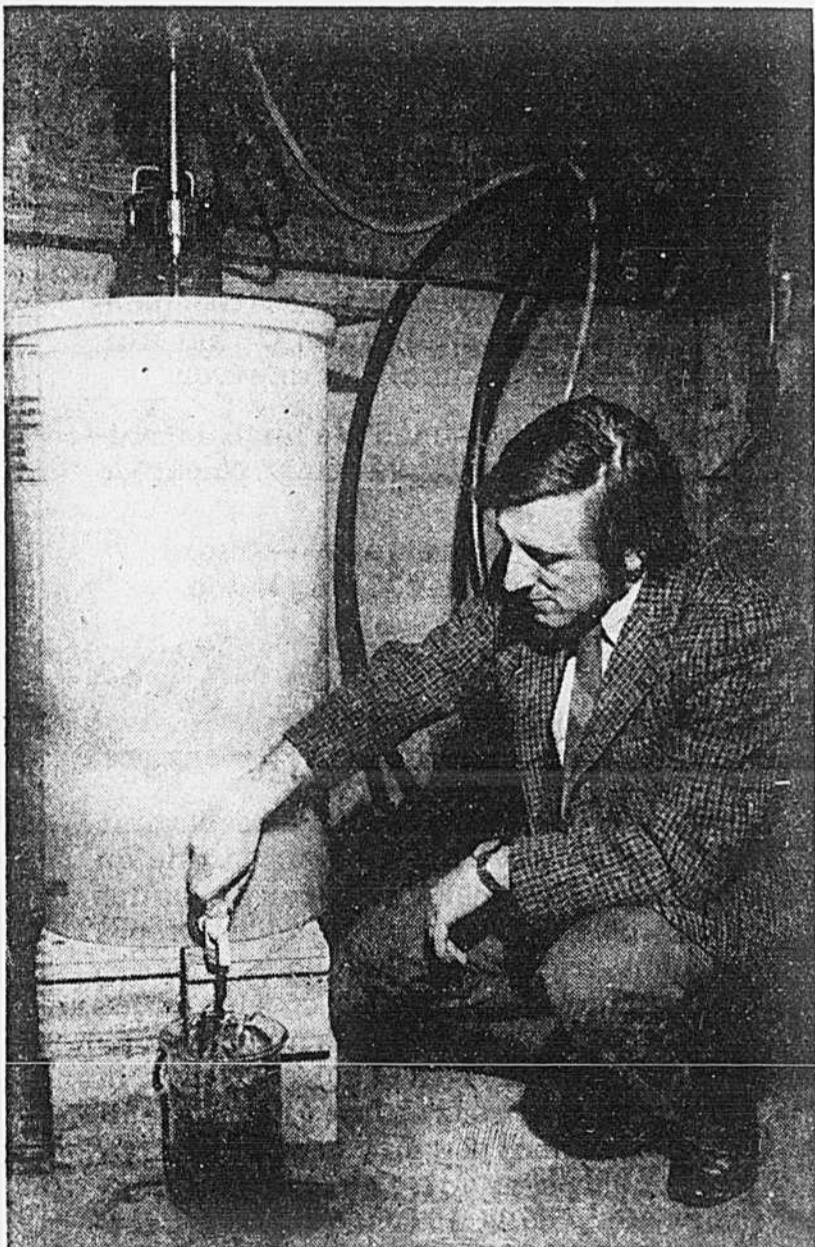
Une installation rudimentaire, qui a pourtant permis de déterminer la valeur adsorbante de la tourbe pour le mercure.
