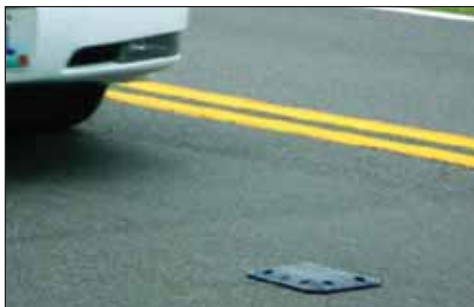
Figure 2 : Exemple de plaque de comptage électronique du trafic
