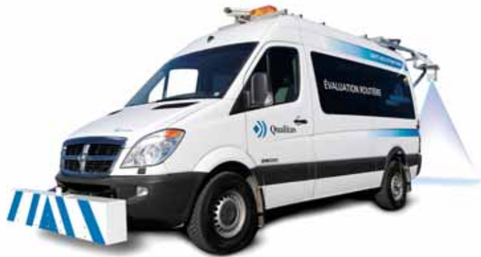
Figure 1 : Véhicule d'auscultation des chaussées
