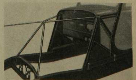
Le renforcement triangulaire... adapté à l'auto... le stabilisateur de torsion du châssis Hupmobile... plus d'oscillation ni de vibration de l'avant.
