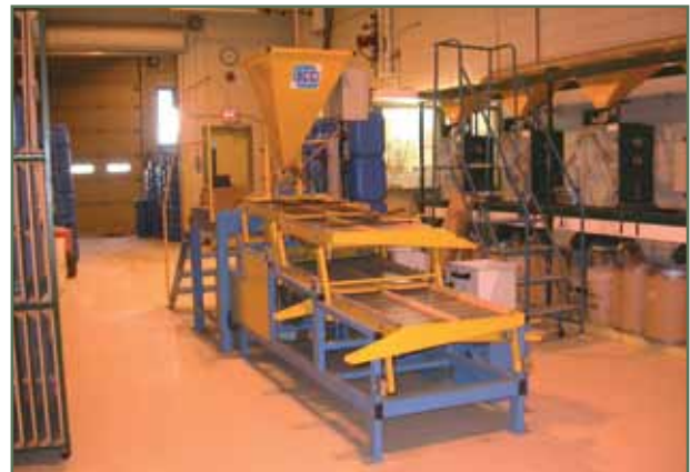
Figure 1 : Crible BCC utilisé au CSFB pour la réalisation de la séparation des graines par grosseur. Photo M. Bettez.
