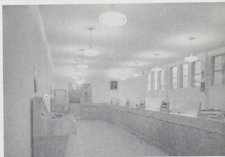
Le comptoir bancaire. L'étroitesse du terrain obligeait à un mur aveugle d'un côté et la proximité de l'édifice voisin était un sérieux obstacle à la pénétration de la lumière diurne. On a dû compenser par un éclairage artificiel bien calculé et l'option pour un mur de façade transparent.
