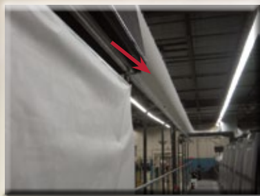
Une fois en haut sur la presse, le rail mobile s'aligne sur le rail de distribution qui fait toute la longueur de la presse. Les travailleurs acheminent les plaques aux unités d'impression en les faisant glisser sur le rail.
