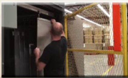
Entre deux armoires de rangement des plaques, on a installé un rail mobile qui se déplace de haut en bas sur un système de guidage motorisé par des chaînes.
