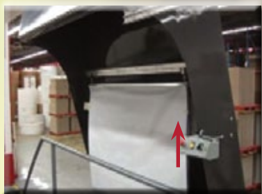
Le rail peut transporter un groupe de plaques pour un lot de production pouvant contenir jusqu'à huit plaques à la fois.
