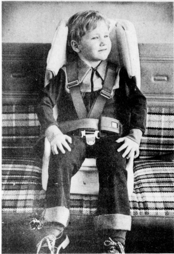
Le "siège chéri" General Motors pour enfant est offert par les concessionnaires GM et il est également vendu directement par General Motors of Canada. Conçu pour les enfants dont le poids ne dépasse pas 40 livres et dont la taille n'excède pas 40 pouces, ce siège doit être utilisé dans les véhicules dûment équipés de ceintures à l'avant et à l'arrière. Si le dossier des sièges avant est articulé ou pliant, il doit être muni d'un dispositif de verrouillage qui le maintient en position relevée. Quand le siège pour enfant est utilisé à l'avant, la ceinture de siège doit être bouclée pour maintenir l'enfant et la sangle supérieure doit être fixée à la ceinture du siège arrière. Quand le siège pour enfant est placé à l'arrière, la sangle supérieure doit être fixée à l'ancrage métallique placé sous la plaque arrière.
