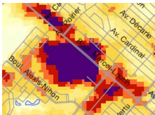
Carte des îlots de chaleur. La température en mauve oscille entre 38 °C et 42°C (2005).
