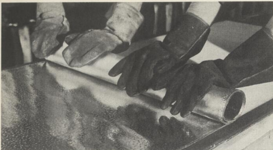
L'alliage de plomb et d'étain qui servira à la confection des tuyaux vient d'être coulé.
