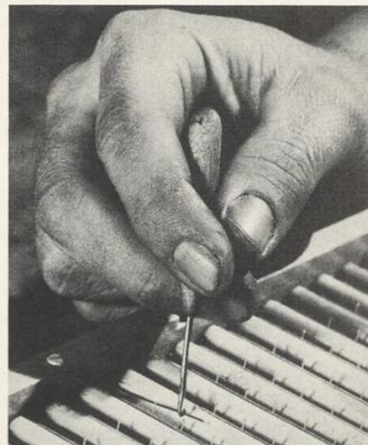
Ajustage du mécanisme de contact dans la console.
