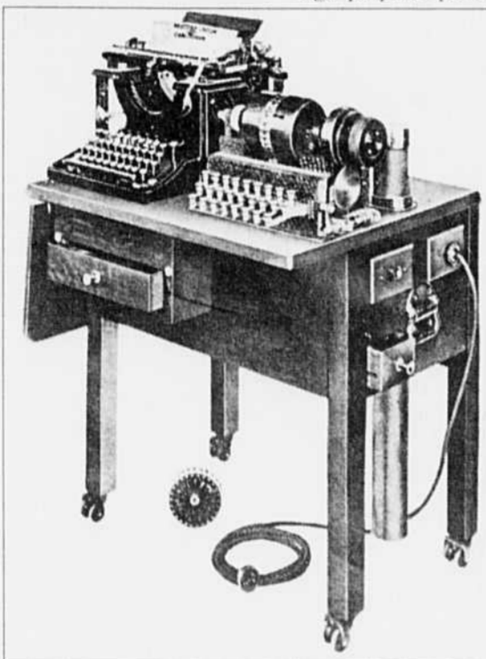
En haut, l'appareil de codage utilisé par l'armée américaine durant la Seconde Guerre. En bas, un des premiers appareils électriques de codage.
