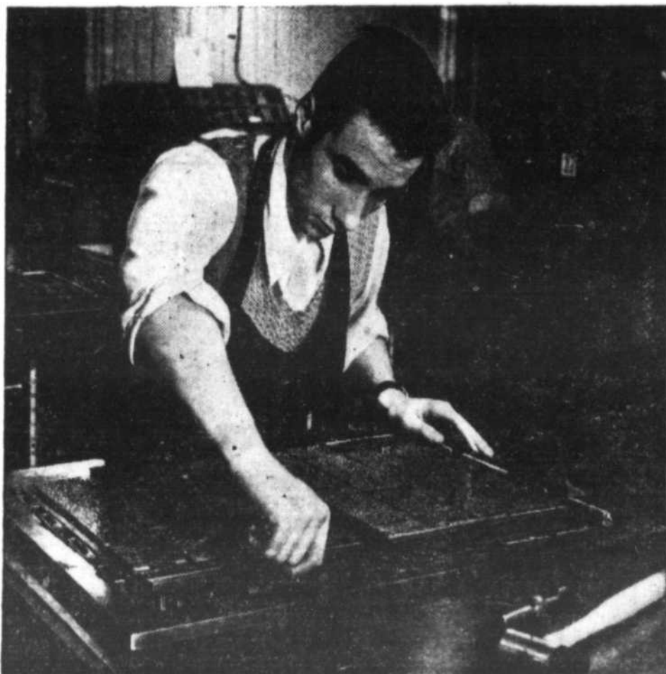
L'élève procède au serrage de la forme. Une forme bien montée ne provoquera pas de levage en cours d'impression. (Photo Armour Landry)
