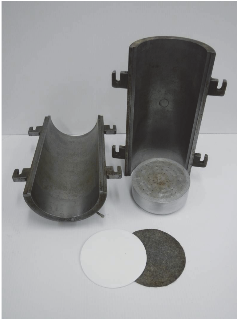
Figure 18 Moule en deux sections utilisé pour le compactage avec plateaux de chargement, géotextiles et papiers filtres
