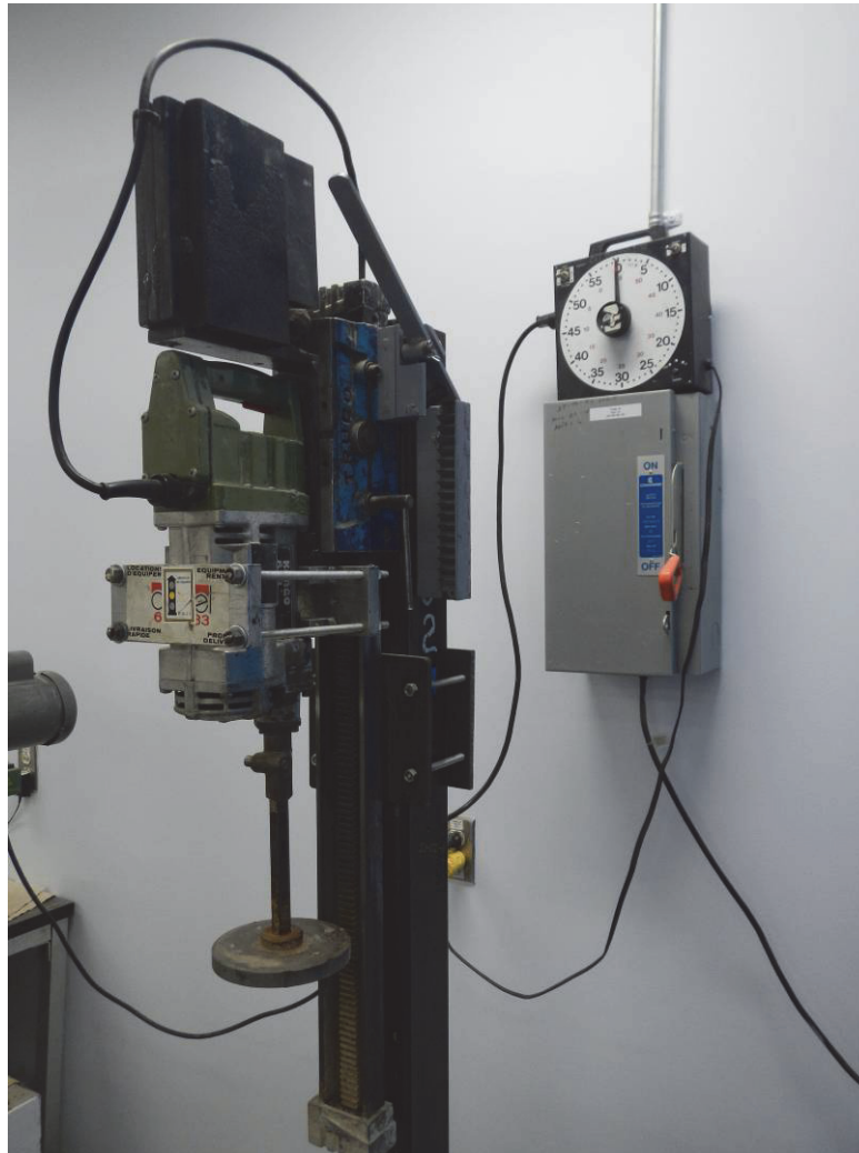
Figure 17 Marteau vibrant installé sur un rail vertical
