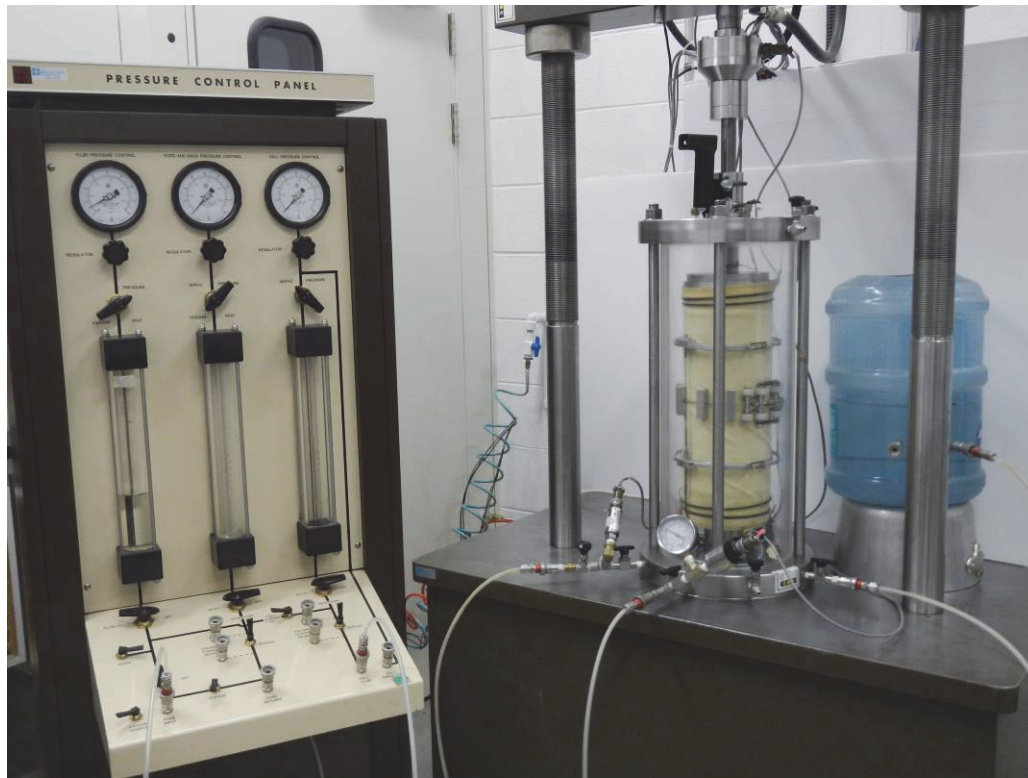
Figure 30 Cellule triaxiale saturée avec le niveau d'eau au centre de l'éprouvette
