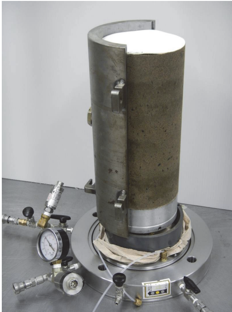
Figure 20 Démoulage de l'éprouvette de matériau granulaire sur la base de l'équipement triaxial à chargements répétés
