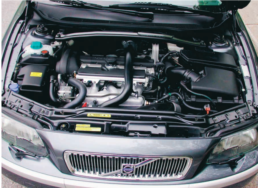
Monté transversalement, ce cinq-cylindres de 2,5 litres suralimenté par turbocompresseur est à la fois performant et onctueux. Sa consommation urbaine fait cependant tousser.
