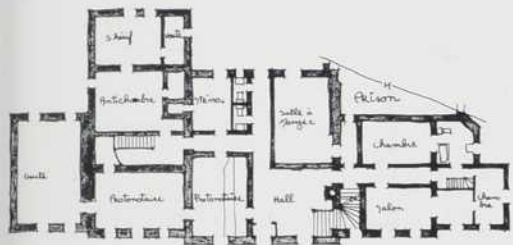
plan du rez-de-chaussée - (existant)
