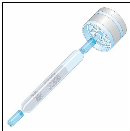
Figure 32. Cassette munie d'un filtre en FV (IRSST 911) et tube XAD-2 (IRSST 2187)
