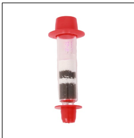
Figure 33. Tube OSHA Versatile Sampler (OVS) avec XAD-2 de SKC
