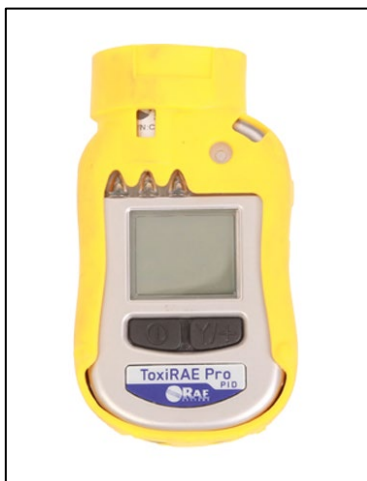
Figure 14. Détecteur ToxiRAE Pro (Honeywell)
