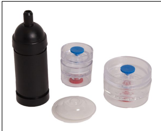
Figure 28. Cassettes et filtre avec nacelle
