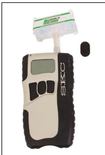
Figure 44. Train de prélèvement pour les spores de moisissures
