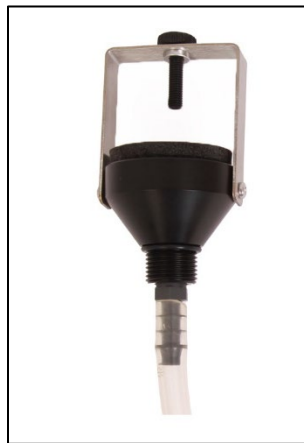
Figure 30. Exemple d'adaptateur pour la vérification du débit d'une cassette inhalable
