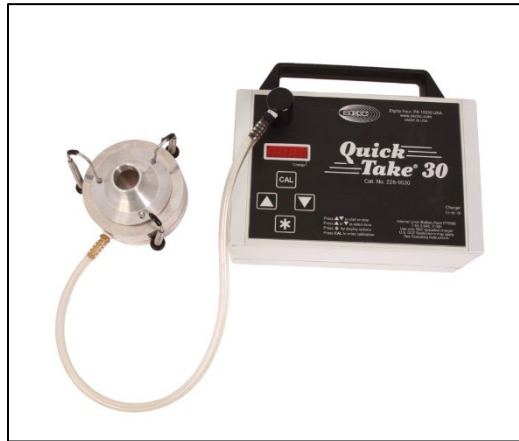
Figure 41. Train de prélèvement pour l'impaction de microorganismes sur gélose à l'aide d'un impacteur Andersen 1 étage (N-6), aussi appelé « ensemble impacteur »
