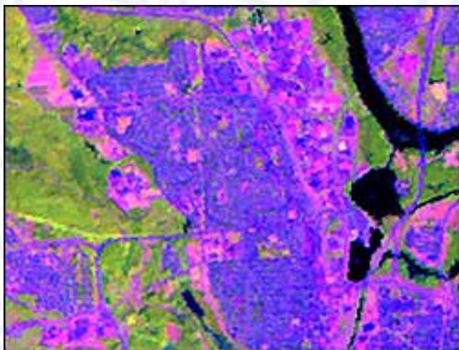
Spatiocartes d'un milieu urbain dans la région de Hull. À gauche, la première génération d'images Landsat-TM 5-4-3. À droite, la deuxième génération d'images Landsat-ETM 5-8-3, qui présente le détail urbain de façon impressionnante.
