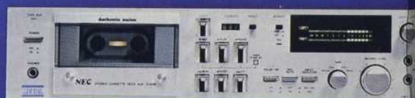
AUK 8300E Magnéto-cassette compatible avec ruban métal tête sendust, dolby, servo-moteur, indicateur de puissance digital et fluorescent.
