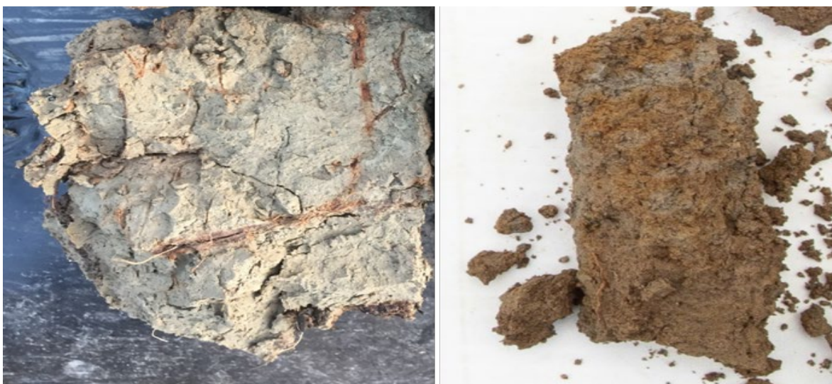
Figure 4.7 : Marbrures peu nombreuses (photo de gauche) et marbrures excessivement nombreuses (photo de droite) (source : IRDA)
