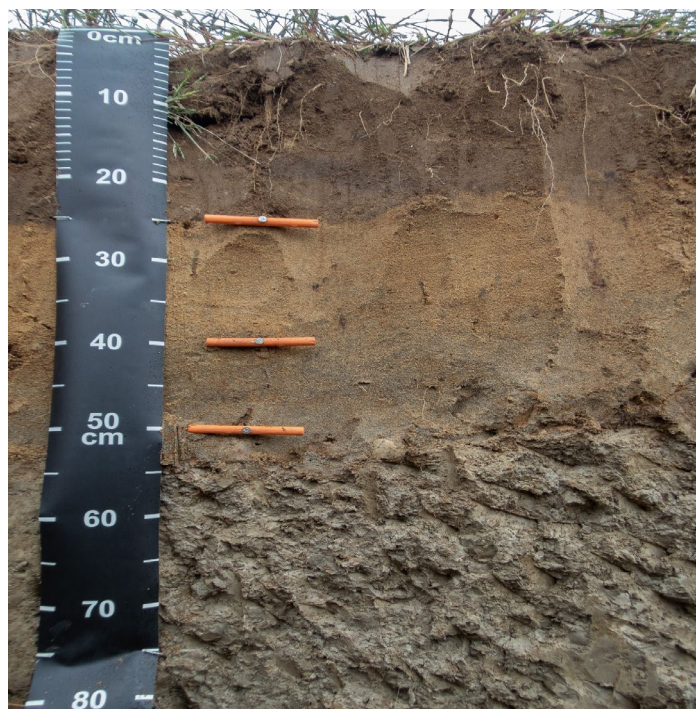
Figure 5.3 : Profil de sol présentant des conditions d'oxydation complètes suivi d'un horizon gleyifié (source : IRDA)
