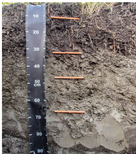
Figure 5.2 : Profil d'un gleysol présentant un horizon fortement réduit (source : IRDA)
