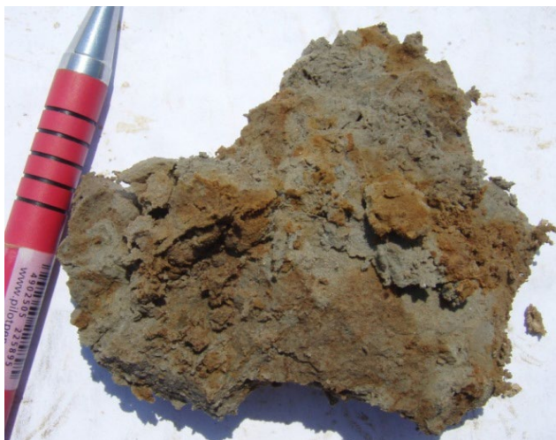
Figure 4.6 : Marbrures 10YR 4/6 (brun jaunâtre foncé) sur une matrice 5Y 5/2 (gris olive) provenant d'un horizon gleyifié (source : Michaël Leblanc)
