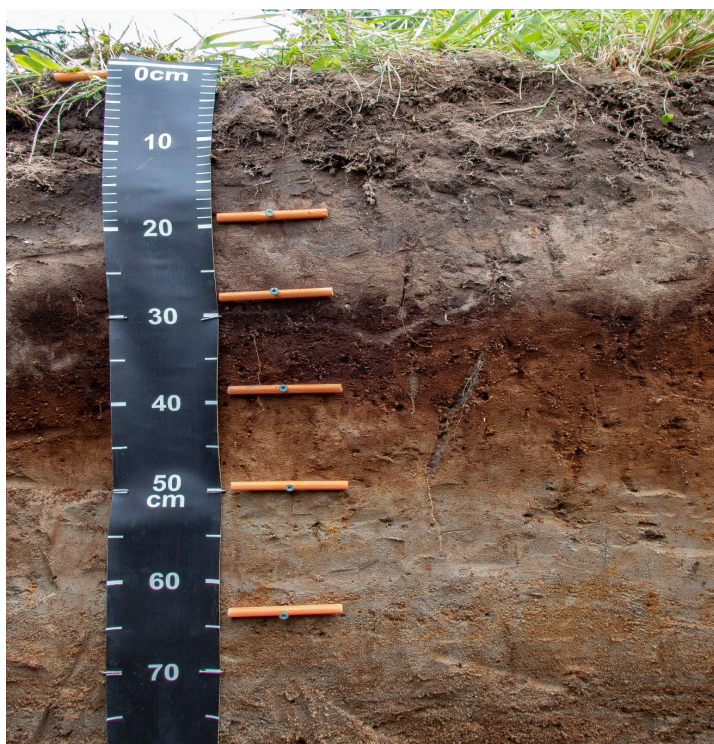
Figure 5.5 : Profil d'un sol de la série Saint-Jude présentant un horizon éluvial (Ae) de 19 à 38 cm de profondeur (source : IRDA)
