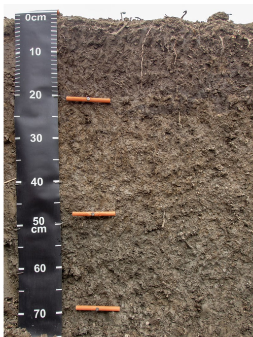
Figure 5.4 : Profil d'un sol de la série Saint-Urbain caractérisé par un horizon gleyifié à partir d'une profondeur de 20 cm qui correspond au NMES (source : IRDA)
