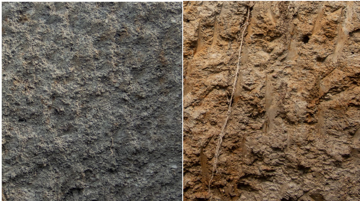
Figure 4.9 : Marbrures distinctes (photo de gauche) et marbrures très marquées (photo de droite) (source : IRDA)
