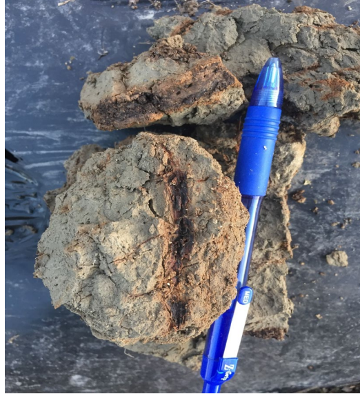
Figure 5.1 : Zones grisâtres appauvries en pigments de fer et zones enrichies en fer (concentrations ou marbrures) d'une couleur allant du rougeâtre au brunâtre (source : Gilles Gagné)
