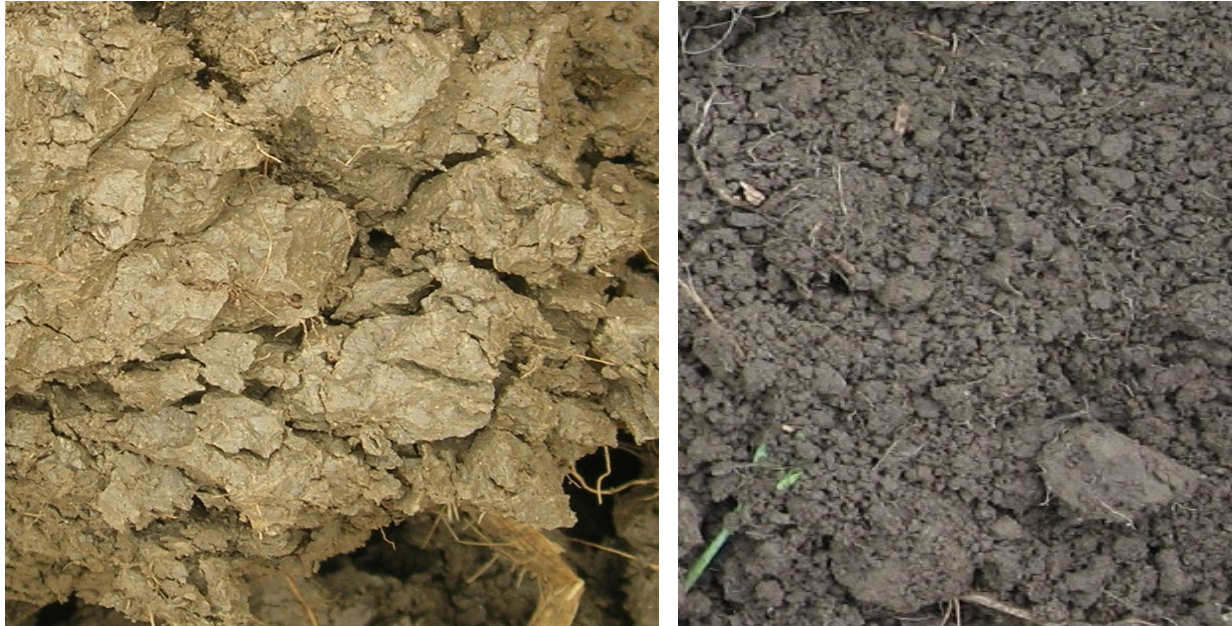
Figure 4.16 : Structure polyédrique angulaire (photo de gauche) et structure polyédrique subangulaire (photo de droite) (source : Groupe PleineTerre inc.)
