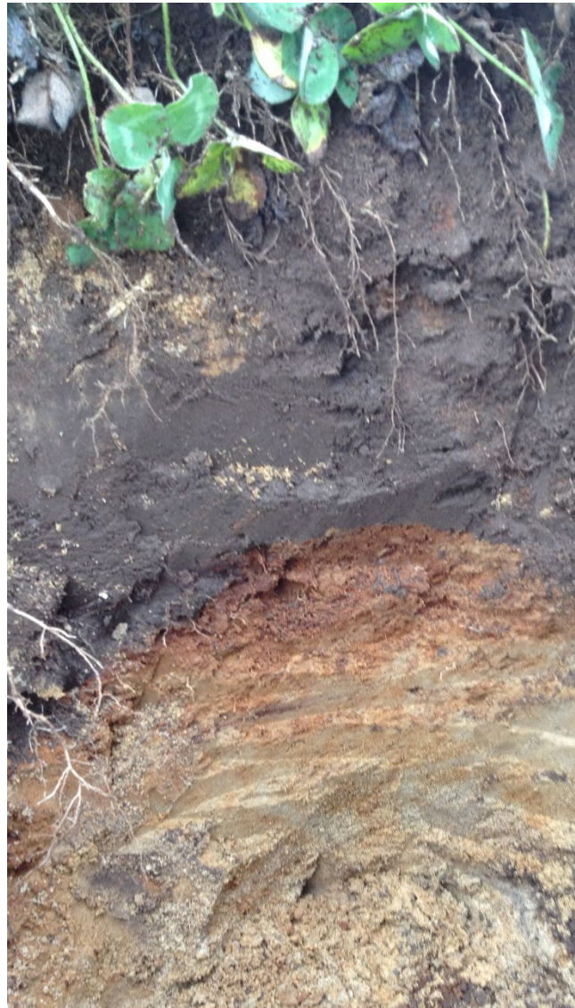
Figure 4.20 : Horizon à ortstein, couche brun rougeâtre (source : Groupe PleineTerre inc.)
