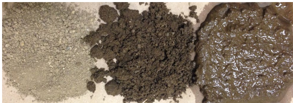
Figure 4.5 : Loam sableux 15 à l'état sec, humide et trempé (source : Michaël Leblanc)
