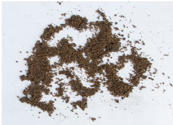
Figure 4.13 : Structure particulaire (source : IRDA)
