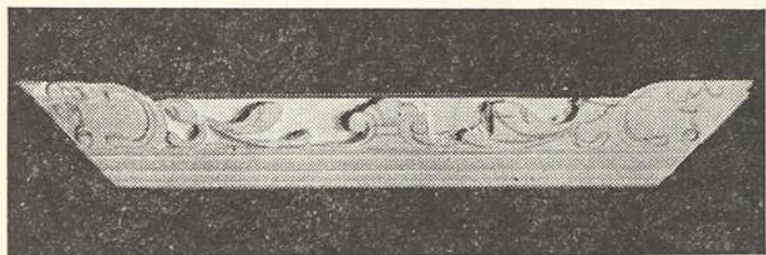
FIG. 4. — En suivant le contour du dessin, le bois est baissé pour donner la saillie désirée.
