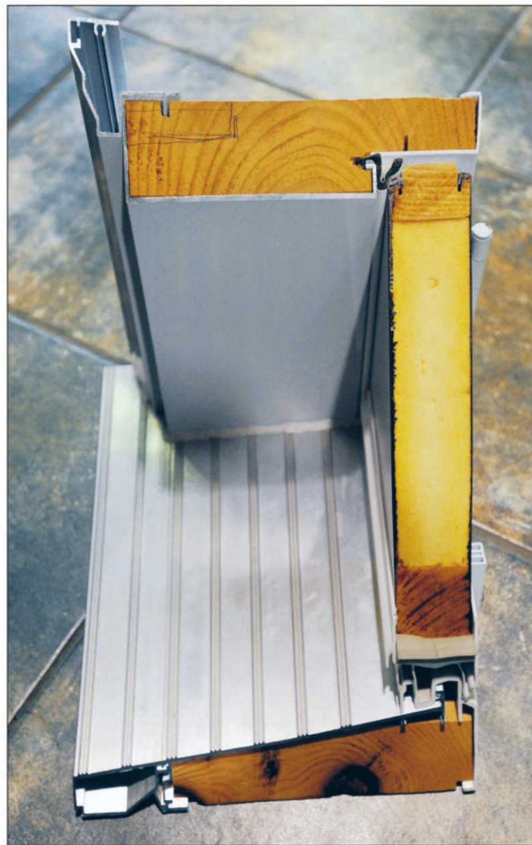
La porte en acier est composée d'un bâti de bois, avec un cœur de polyuréthane, recouvert de deux feuilles d'acier. — PHOTO LE SOLEIL, ERICK LABBÉ
